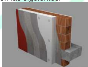
Fachada con un aislamiento térmico por el exterior (SATE o prefabricado con plaqueta cerámica vista)
